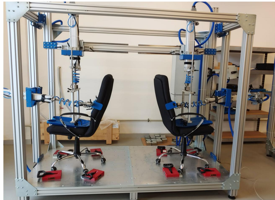
Echipament pentru testarea oboselii scaunului și spătarului
