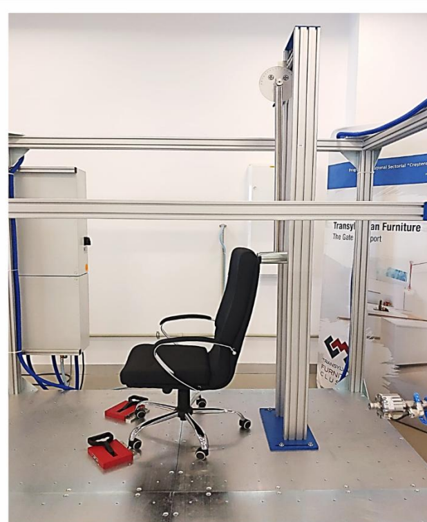
Echipament pentru testarea stabilității și durabilității în caz de impact
