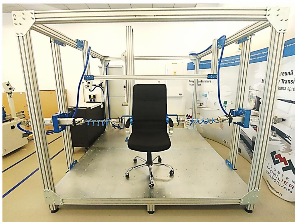
Echipamente pentru testarea durabilității canapelelor și testarea suporturilor verticale de braț de susținere în direcție verticală
