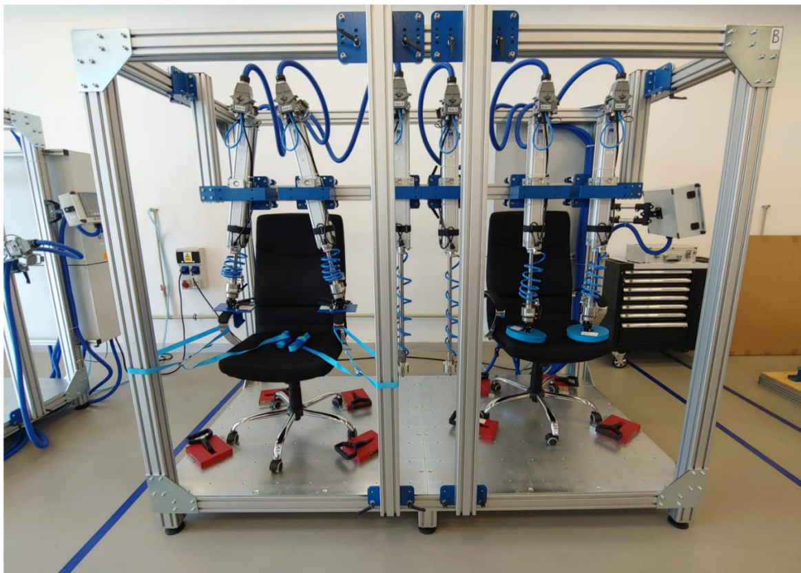
Echipament pentru încărcarea statică a suporturilor de braț, lateral (orizontal)
